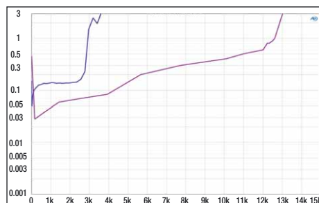
Bei der 13000er gibt es 3 kW an 4 Ohm, die 13 kW werden bei 3 % THD+N erreicht (und die 2 Ohm Messung fehlt)
