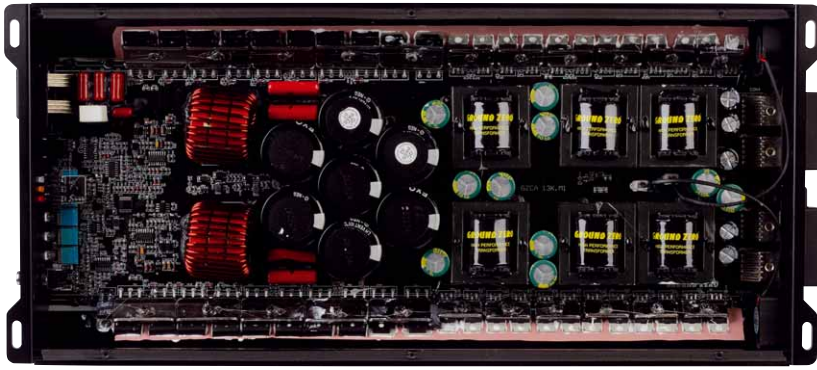
In den Netzteilen versorgen sechs, vier und zwei kubische Trafospulen die Verstärkungen. Alle Verstärker fallen extrem kompakt für die gebotene Leistung aus
